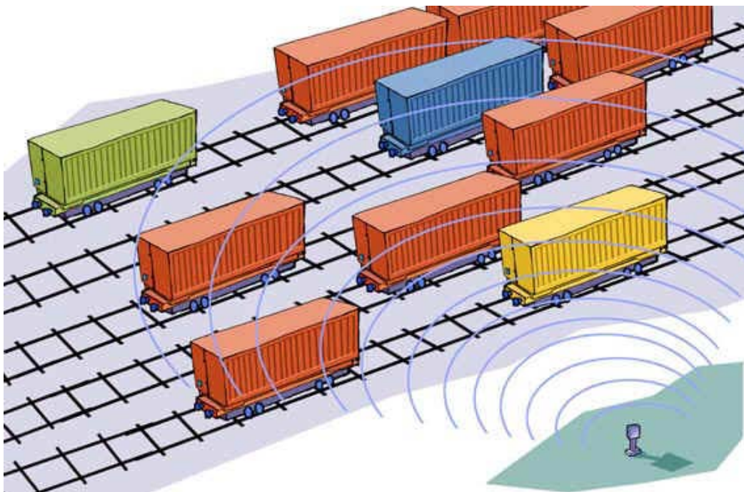
Obrázok 2: Princíp fungovania RFID systému v železničnej doprave
