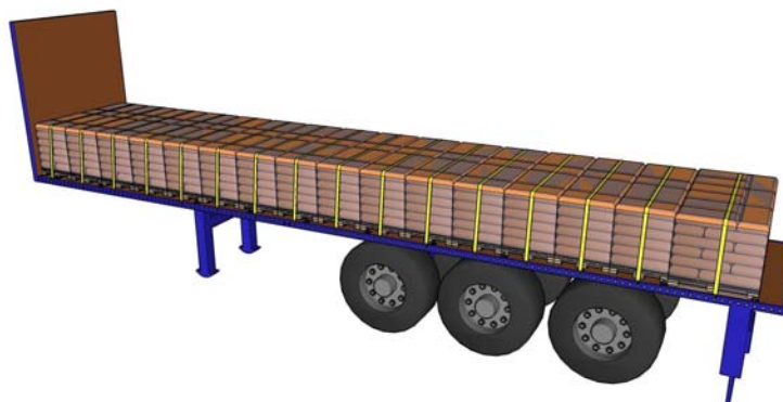
Obr. 2 Náklad vriec – 6 vrstiev – 33 paliet – 15,8 tony – nevyužitie kapacity návesu
