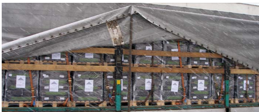
Obr. 3 Náklad vrec – 2 vrstvy paliet – 46 paliet (14 vo vrchnej vrstve) – 22 ton
