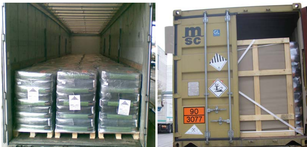
Obr. 7 Nové riešenie nakládky a upevnenia nákladu v návese s bočnicami a 20' kontajneri
