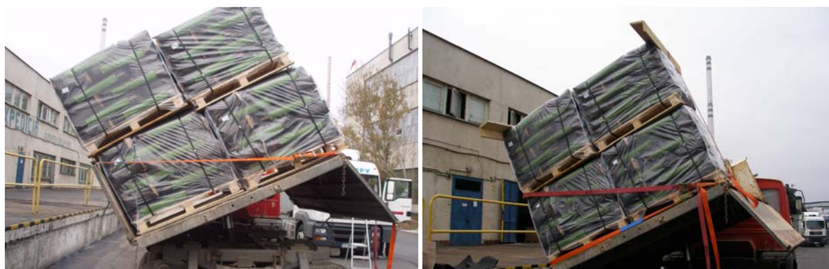
Obr. 4 Porovnanie upevnenia dvoch vrstiev paliet s použitím a bez použitia ochranných rohovníkov – posun nákladu vľavo a bez posunu vpravo
